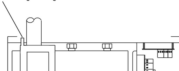
Im linken Edelstahlrohr (siehe Skizze) befindet sich eine Öffnung, die für die Belüftung des Systems unbedingt erforderlich ist. Diese Öffnung darf keinesfalls verschlossen werden. Ein Verschließen dieser Öffnung würde unweigerlich zu Funktionsstörungen der Anlage führen. Falls bei Betrieb der Anlage aus dieser Öffnung Wasser austritt, ist möglicherweise der Abfluss nicht ausreichend dimensioniert oder verstopft.
