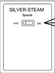
Durch Betätigen des oberen **Schalters** wird der Dampfgenerator ein- und ausgeschaltet.
