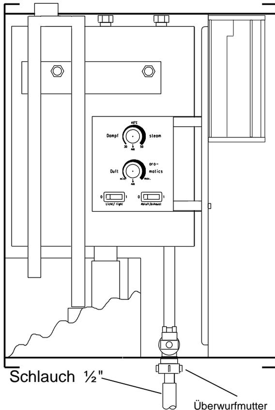
Für den Wasseranschluss ist ein druckfester ½“ Waschmaschinen- Anschluss Schlauch mit 90° Winkelanschluss und R¾“ Gewinde zu verwenden. Dieser Schlauch wird mit Hilfe der daran befindlichen Überwurfmutter an dem Gewindeanschluss des Magnetventils wasserdicht verschraubt.
