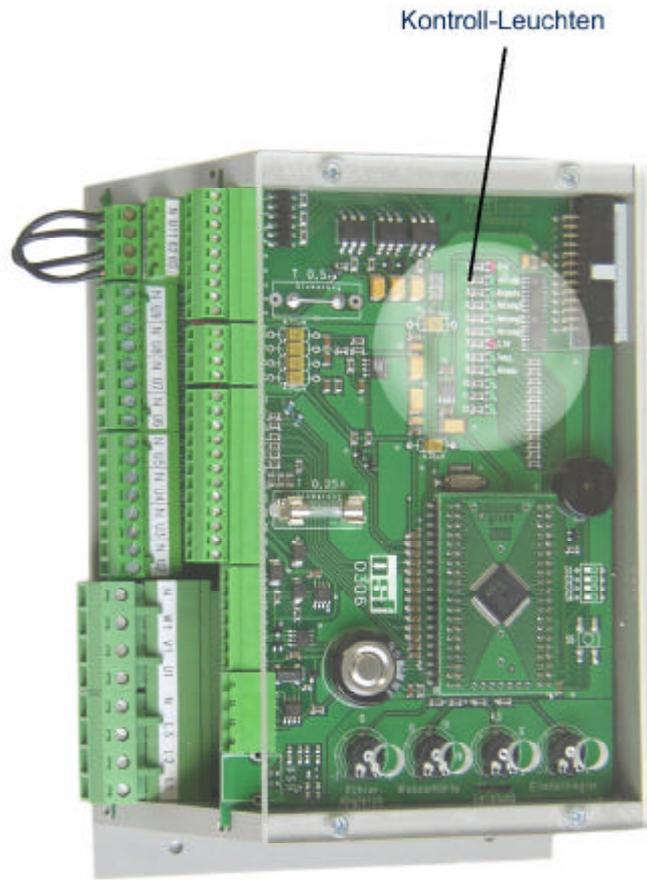
Die Steuerelektronik beinhaltet einige Kontroll-Leuchten, mit deren Hilfe die Funktionskontrolle bzw. Fehleranalyse vorgenommen werden kann.
